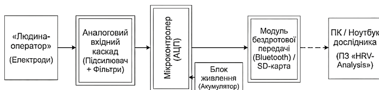
Рисунок 3 – Структурна схема апаратно-програмного комплексу «HRV-Analysis System»
