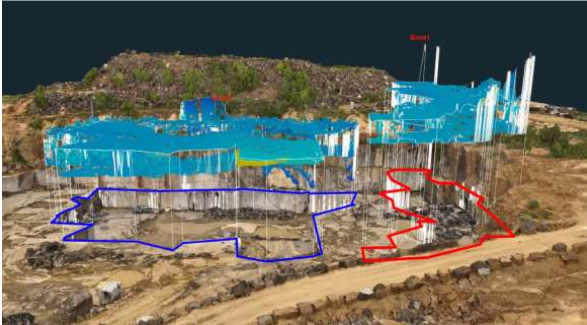
Рис. 1. Візуалізація порівняння 3D-моделей кар'єру за 2024 та 2025 роки з виділеними полігонами зон інтересу: блок 1 (червоний контур) та блок 2 (синій контур). На моделі показано різницю геометрії уступів і обсягів виїмки порівняно з попереднім роком (2025 рік).
