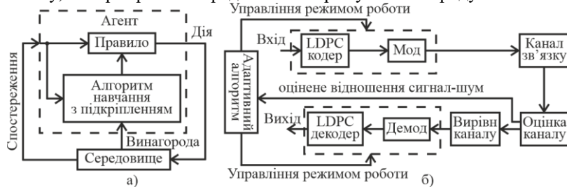
Рис. 1. а – Схема взаємодії агента RL з середовищем; б – схема системи зв'язку, що використовує навчання з підкріпленням (RL)
