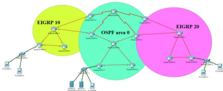
Рисунок 2 – Ієрархічна топологія мережі в середовищі Cisco Packet Tracer
