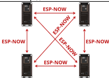
Рис. 1 – Принцип передачі даних за протоколом ESP-NOW
