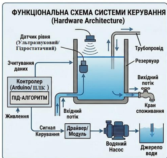
Рис.1. Схема апаратної реалізації системи автоматичного керування
