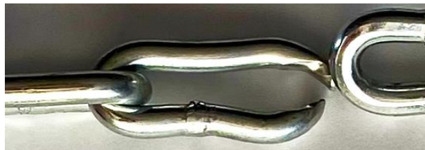
Рис. 4. Здеформована (зруйнована) ланка ланцюга
