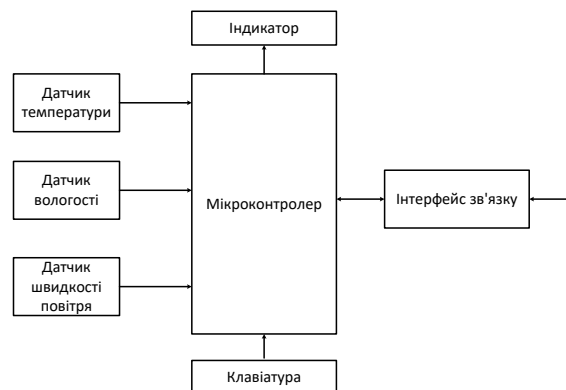
Рис. 1. Структурна схема комп'ютеризованої інформаційно-вимірювальної системи контролю параметрів кліматичної камери для визрівання м'ясних продуктів
