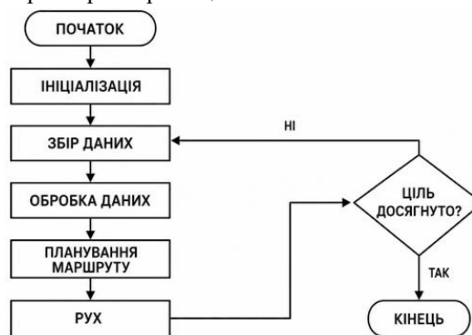
Рис.1. Блок-схема алгоритму збору даних та навігації автономного робота
