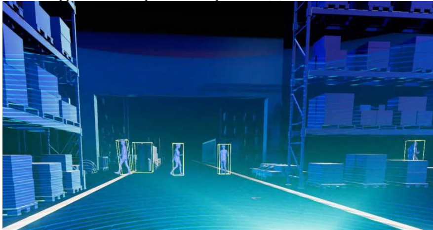
Рис. 1. Результат сканування складського приміщення за допомогою LiDAR-сенсора
